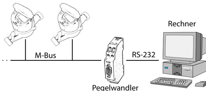
Die Geräte MBUS-PS20 und MBUS-PS80 wandeln die Pegel der seriellen RS-232-Schnittstelle eines PCs (bzw. ähnlicher Geräte) in die Bus-Pegel des M-Bus nach EN 13757. Durch entsprechende Software wird
